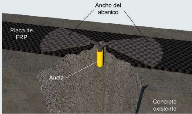
Figura 6.8.8 Conector de CPRF. Fuente: Del Rey et al. (2017) y elaboración propia con base en Zhang y Smith (2011).
