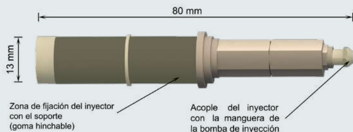
a) Boquilla utilizada en la inyección de resinas epóxicas
