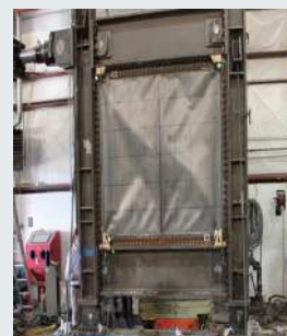
f) Muros de placa de acero
