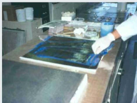
c) Colocación de resina saturante sobre las fibras
