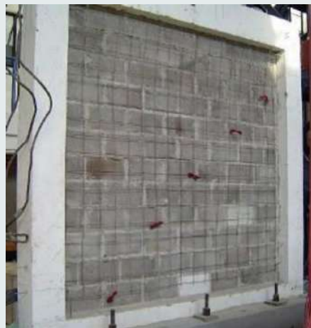
Figura 6.13.1 Marco de concreto con muro diafragma de bloques de mampostería para ser ensayado en laboratorio. Fuente: cortesía del CENAPRED (2019).
