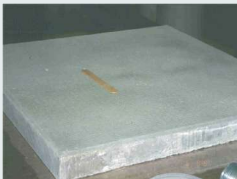
a) Superficie limpia, ya preparada y con resina saturante
