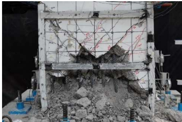
Fig. 3.3.169 Estado final del daño cara norte - Columna C-2 (Instituto de Ingeniería, 2021 - 2023)
