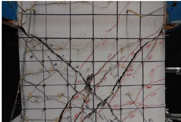
Fig. 3.3.87 Cara norte ( R=2\% ) - Columna O* (Instituto de Ingeniería, 2021 - 2023)
