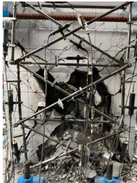
Fig. 3.3.54 Estado final cara sur - Columna OR (Instituto de Ingeniería, 2021 - 2023)
