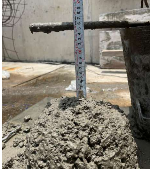
Fig. 2.6.1 Prueba de revenimiento (Instituto de Ingeniería, 2021 - 2023)
