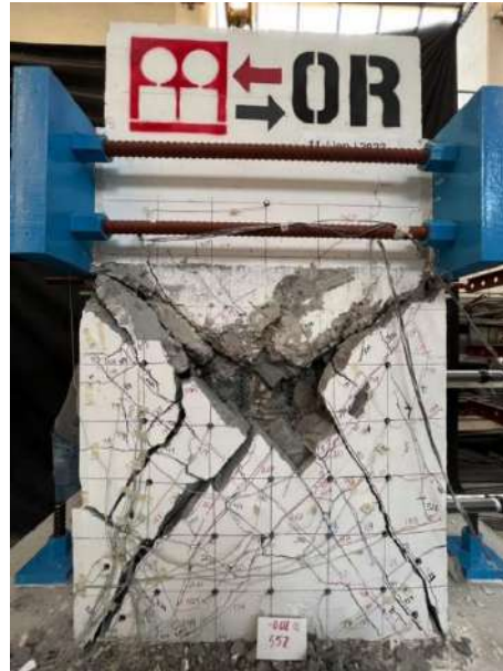
Fig. 3.3.52 Cara norte ( R=-2\% (2)) - Columna OR (Instituto de Ingeniería, 2021 - 2023)
