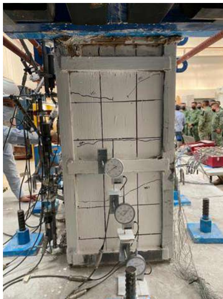
Fig. 3.3.115 Primeras grietas en la cara este - Columna C-2 (Instituto de Ingeniería, 2021 - 2023)
