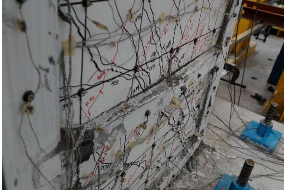
Fig. 3.3.201 Deformación en solera intermedia cara norte - Columna C-4 (Instituto de Ingeniería, 2021 - 2023)
