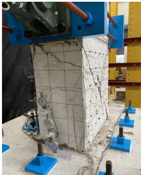
Fig. 3.3.8 Column O vista lateral (R=-1%) (Instituto de Ingeniería, 2021 - 2023)
