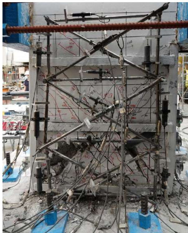
Fig. 3.3.148 Cara sur ( R=4\% ) - Columna C-2 (Instituto de Ingeniería, 2021 - 2023)
