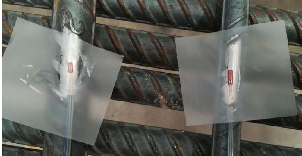
Fig. 2.5.5 Pegado de strain gauge (Instituto de Ingeniería, 2021 - 2023)
