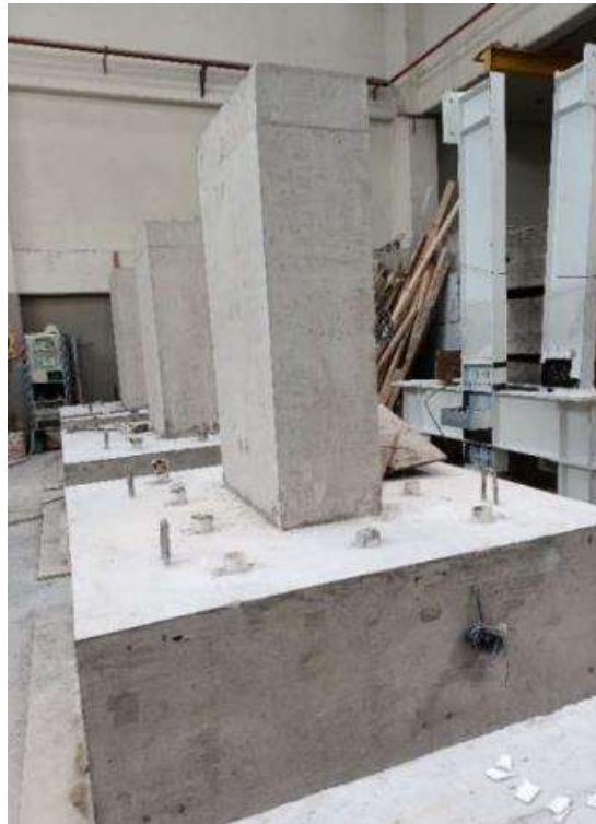
Fig. 2.5.19 Especímenes curados y fraguados (Instituto de Ingeniería, 2021 - 2023)
