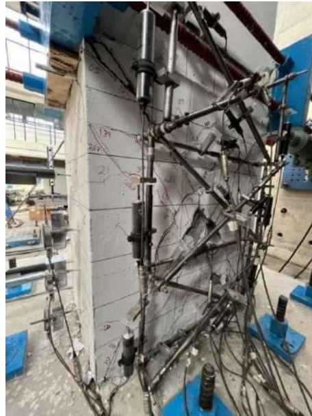
Fig. 3.3.48 Estado cara sur ( R=1.5\% ) - Columna OR (Instituto de Ingeniería, 2021 - 2023)
