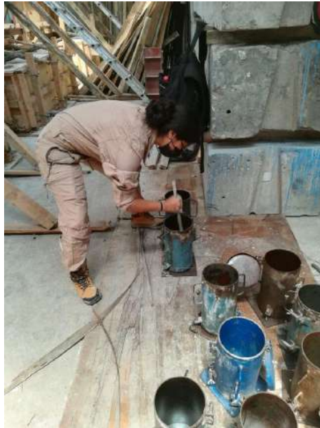
Fig. 2.6.2 Elaboración de cilindros de concreto (Instituto de Ingeniería, 2021 - 2023)
