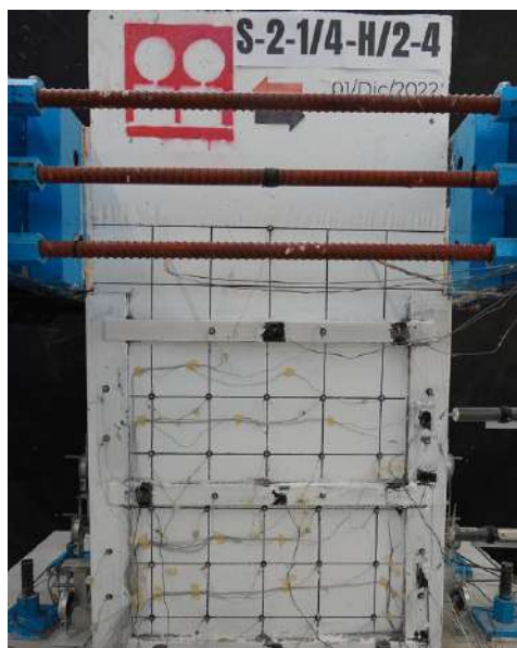
Fig. 3.3.185 Modelo al inicio de la prueba – Columna C-4 (Instituto de Ingeniería, 2021 - 2023)
