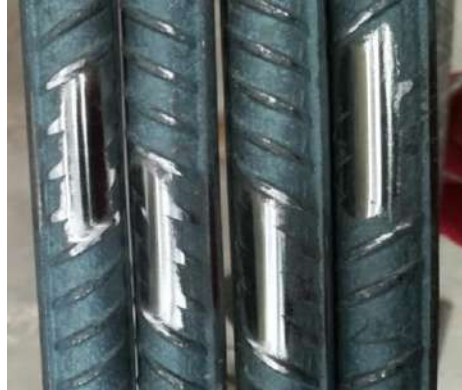
Fig. 2.5.4 Acabado tipo espejo (Alcocer, y otros, 2022)
