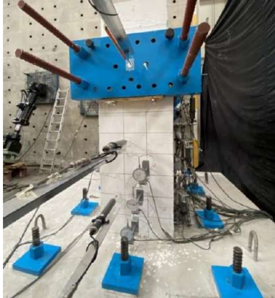
Fig. 3.3.37 Aparición de grietas cara oeste - Columna OR (Instituto de Ingeniería, 2021 - 2023)
