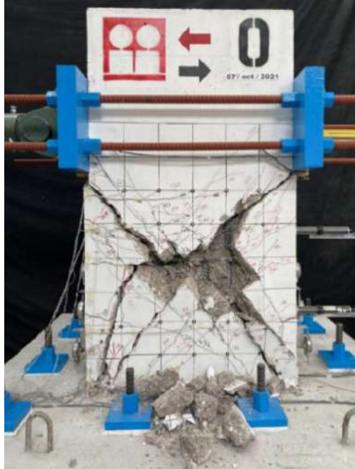
Fig. 3.3.15 Estado final del daño Columna O cara norte (Instituto de Ingeniería, 2021 - 2023)
