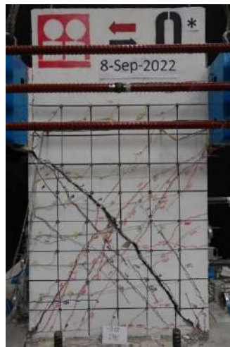
Fig. 3.3.86 Deslizamiento de la columna ( R=2\% ) - Columna O* (Instituto de Ingeniería, 2021 - 2023)
