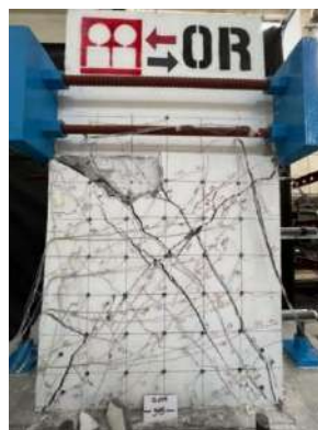
Fig. 3.3.47 Cara norte (R=1.5%) - Columna OR (Instituto de Ingeniería, 2021 - 2023)
