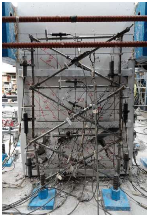
Fig. 3.3.145 Cara sur ( R=4\% ) - Columna C-2 (Instituto de Ingeniería, 2021 - 2023)
