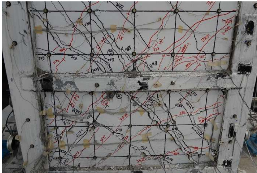
Fig. 3.3.200 Cara norte pausa posterior a R=-4.5\% - Columna C-4 (Instituto de Ingeniería, 2021 - 2023)
