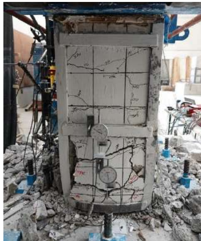
Fig. 3.3.170 Estado final del daño cara este - Columna C-2 (Instituto de Ingeniería, 2021 - 2023)
