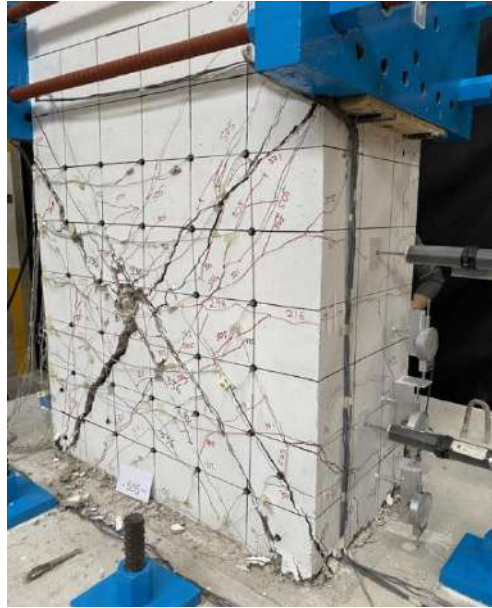
Fig. 3.3.9 Columna O pausa en 0 t posterior a R=-1\% (Instituto de Ingeniería, 2021 - 2023)
