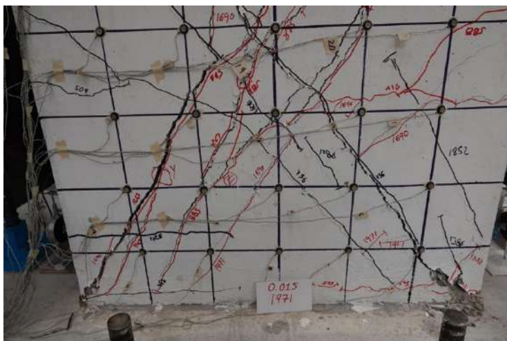
Fig. 3.3.83 Aplastamiento de la columna - Columna O* (Instituto de Ingeniería, 2021 - 2023)
