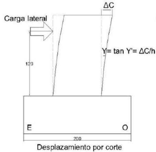
Fig. 3.2.2 Desplazamiento por corte (Instituto de Ingeniería, 2021 - 2023)
