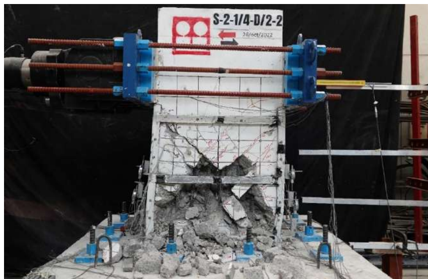
Fig. 3.3.168 Columna en cero t después de R=5\%(2) - Columna C-2 (Instituto de Ingeniería, 2021 - 2023)
