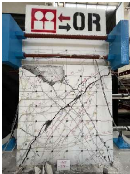
Fig. 3.3.49 Semiciclo ( R=-1.5\% ) - Columna OR (Instituto de Ingeniería, 2021 - 2023)
