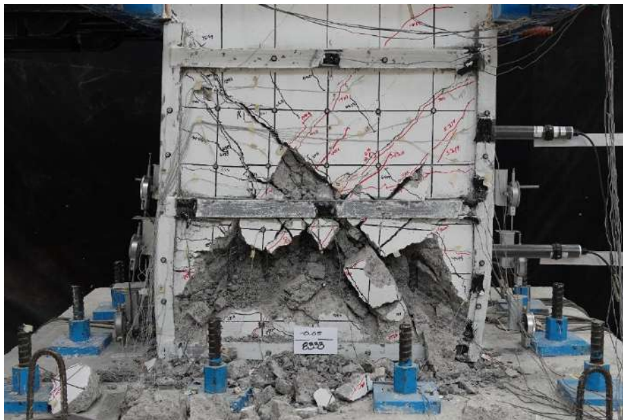
Fig. 3.3.158 Cara norte (R=-5%) - Columna C-2 (Instituto de Ingeniería, 2021 - 2023)
