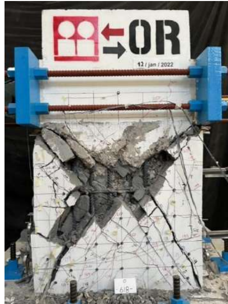
Fig. 3.3.53 Estado final cara norte - Columna OR (Instituto de Ingeniería, 2021 - 2023)
