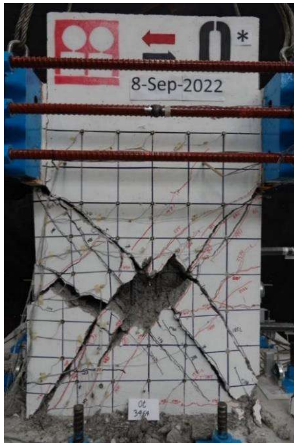
Fig. 3.3.99 Estado final cara norte - Columna O* (Instituto de Ingeniería, 2021 - 2023)
