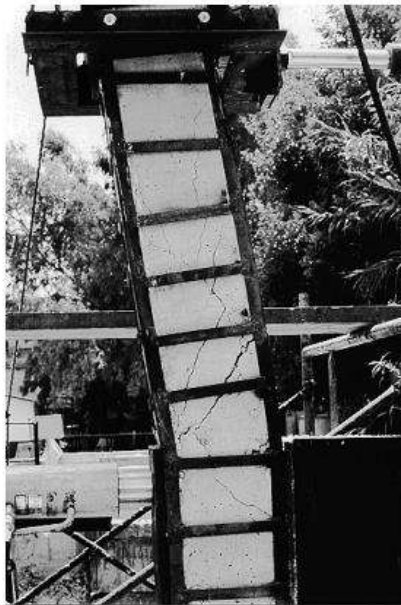
Fig. 1.1.4 Modelo y falla típica (González, 2007)
