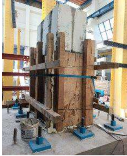
Fig. 3.3.30 Columna después del colado - Columna OR (Instituto de Ingeniería, 2021 - 2023)
