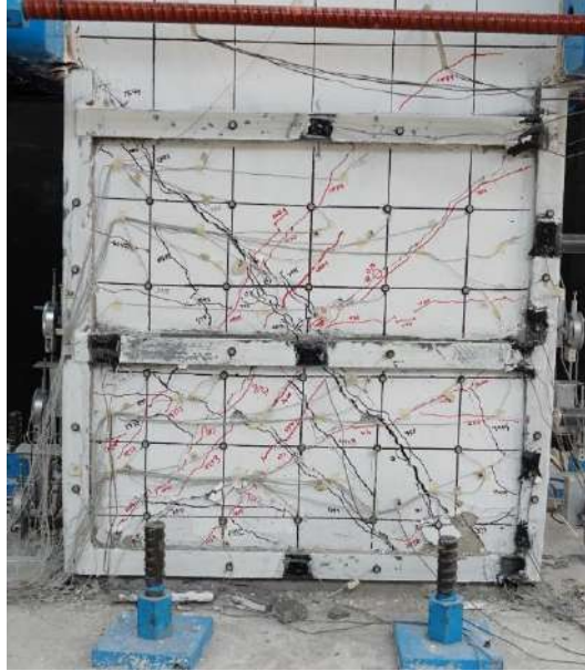
Fig. 3.3.137 Daño después de la distorsión de- 3.5% - Columna C-2 (Instituto de Ingeniería, 2021 - 2023)
