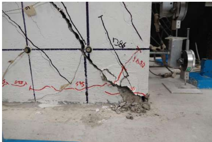
Fig. 3.3.80 Aplastamiento de la columna - Columna O* (Instituto de Ingeniería, 2021 - 2023)
