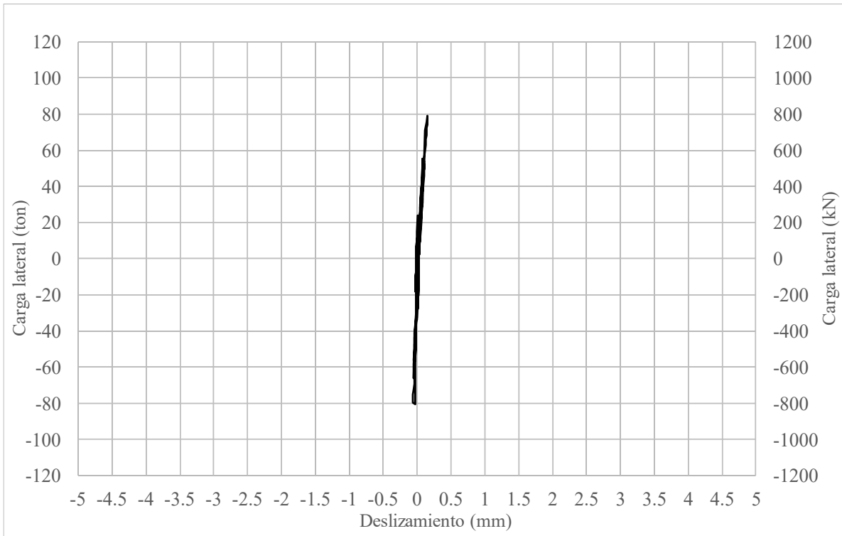
Fig. 3.3.67 Deslizamiento en la base de la columna - Columna OR
