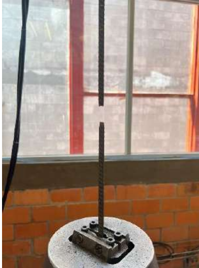
Fig. 2.6.11 Falla en la probeta a tensión (Instituto de Ingeniería, 2021 - 2023)
