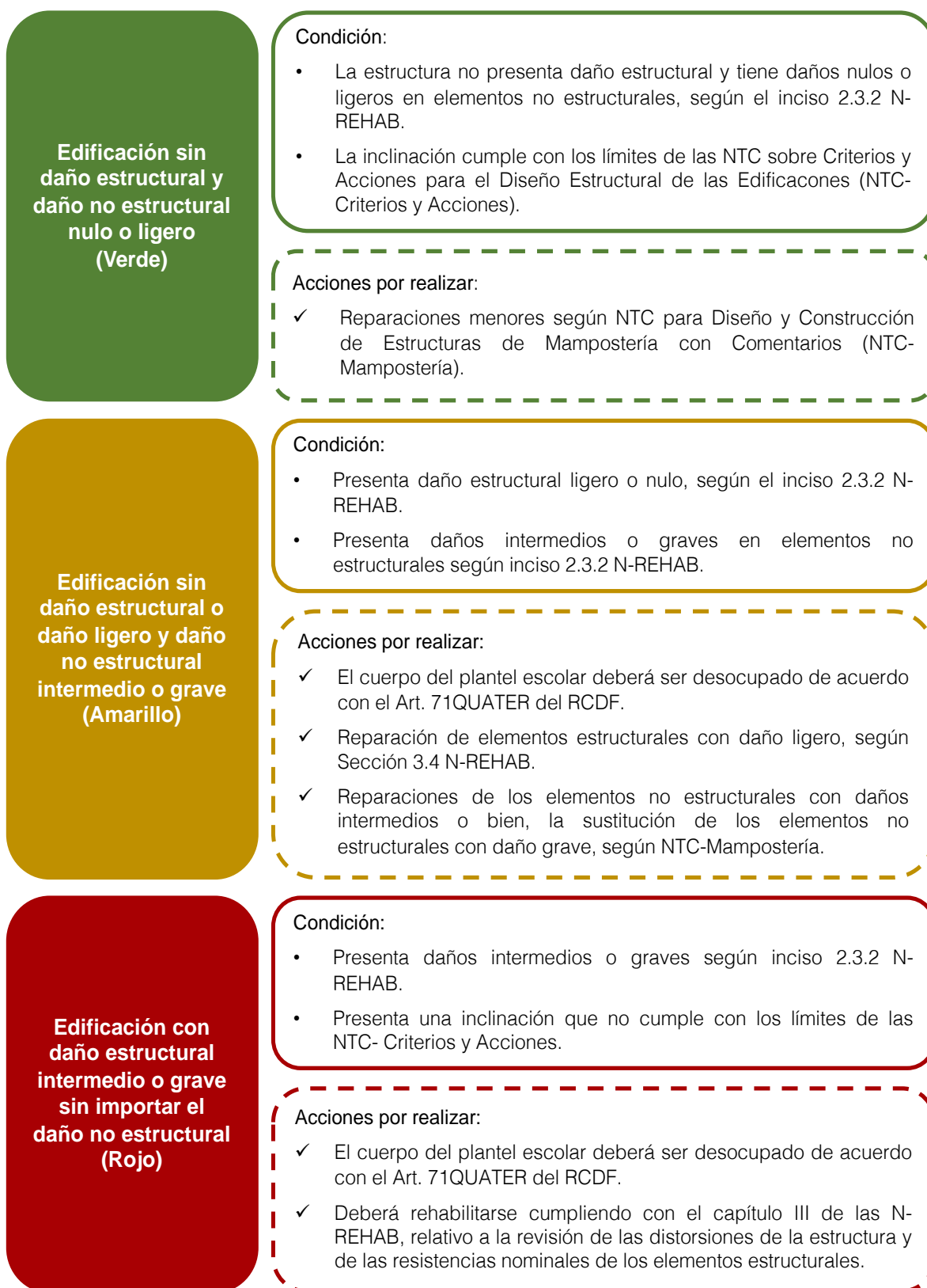
Figura 2.2 Clasificación del impacto de elementos dañados y acciones por realizar en cada caso de conformidad con las N-REHAB.
