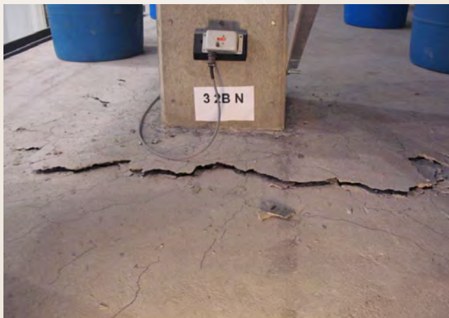
Figura 7.9 a) Agrietamiento característico de una losa plana apoyada en columnas, cerca de la falla. Vista de la cara superior de la losa. b) Falla de la conexión losa-columna - vista de la cara superior de la losa. c) Agrietamiento a la falla de la conexión - vista de la cara inferior de la losa. Fuente: Fick (2008).
