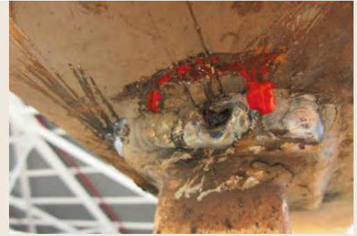
Figura 8.2.5.b Inclusión de escoria. Fuente: https://technoweld.com.au/2019/11/13/the-most-common-welding-defects-causes-and-remedies/
