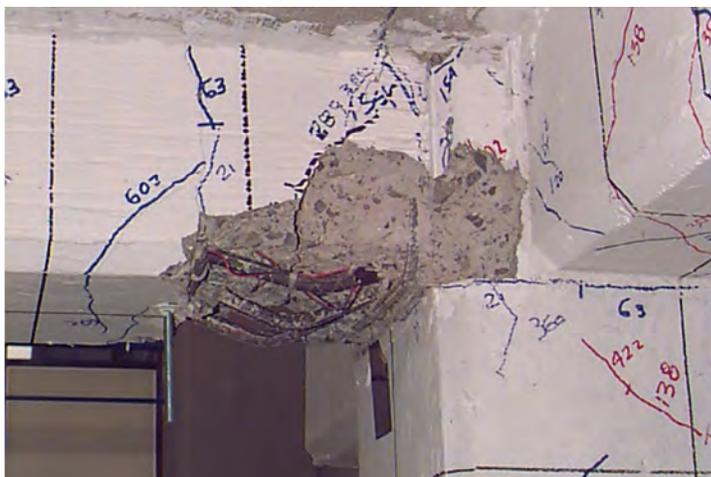
Figura 3.6 Falla por flexión y agrietamiento por tensión diagonal de una viga de concreto, con pandeo del refuerzo longitudinal. Fuente: CENAPRED (2019).
